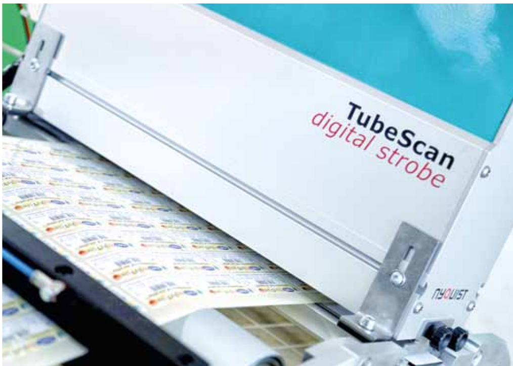
▼ Hochleistungsstroboskop für 100-Prozent-Kontrolle von EAN-Codes | high performance machine for 100%-control of EAN-Codes
